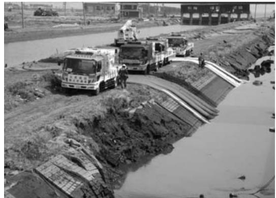
写真-2 排水ポンプ車稼働状況
