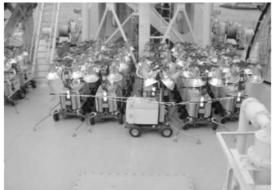
写真-5 船尾隣甲板の発電機付投光器格納状況
