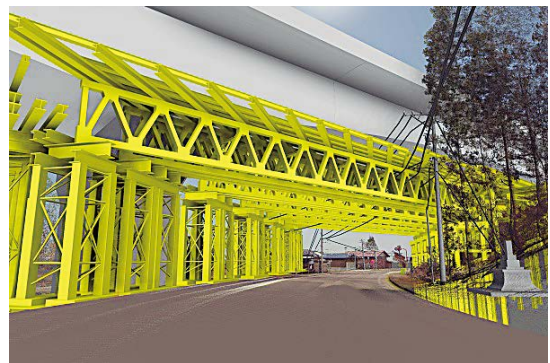
CIMによる国道部支保工設置時の視認性確認
