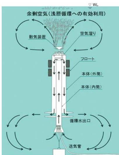
②④水没式複合型曝気装置
