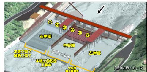
図4 第二床固改築工事の進捗状況
