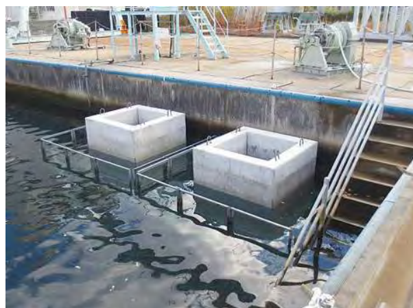
小型ケーソン試験体 長期暴露試験
