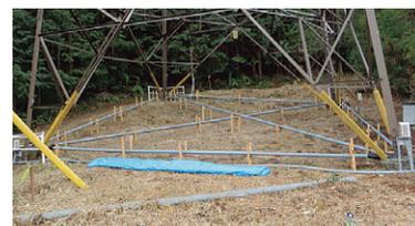
送電鉄塔基部の根開き計測の様子
