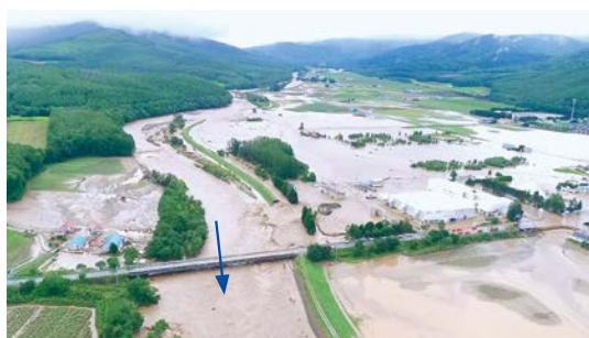
堤防決壊（石狩川水系空知川 平成28年8月31日撮影）
