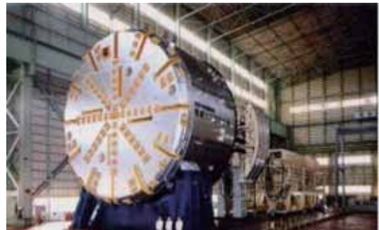
大断面（掘削径12.84m）TBM
