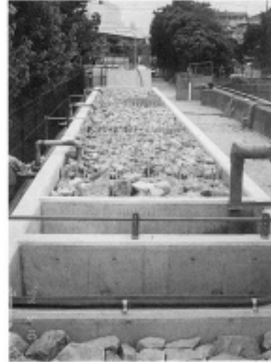
実験水路の礫充填状況
