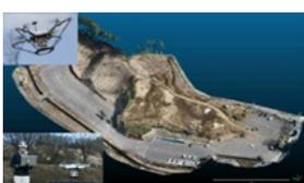
UAVによる写真測量による面的な3次元測量を実施
