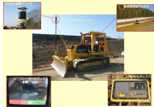
MC技術を用いた施工(ブルドーザ)
