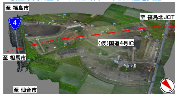
●ドローンによる航空写真測量成果(国道4号IC)
