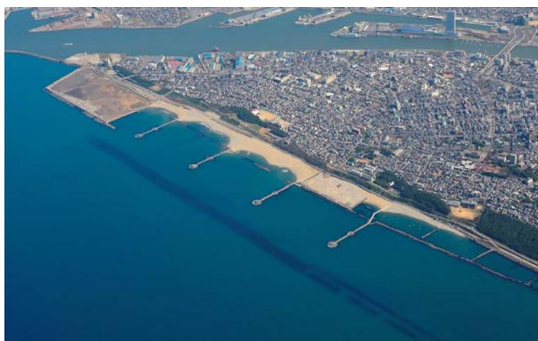
侵食対策工事は、昭和の初めから始まり、縦堤や離岸堤を設置してきましたが、現実には多くの被災、構造物の沈下、飛散等を経験し、その都度復旧と改良が加えられ、この機能を維持するためには、半永久的な補強工事が必要とされました。また、離岸堤の沖合の広い範囲では、依然として海底面の侵食が進んでおり、将来的には離岸堤の倒壊にも繋がりがかねない状況にありました。
