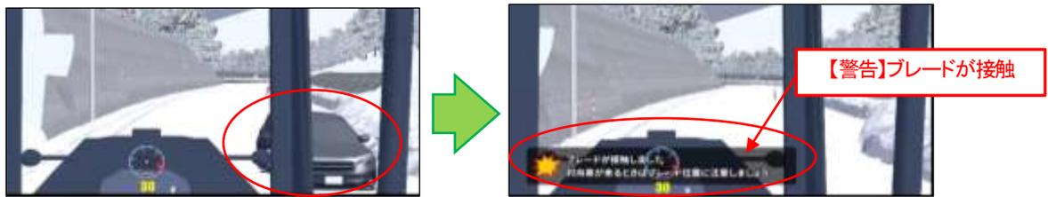
図-5 ヒヤリ・ハットの一例(ブレードが車線をはみ出し対向車両に接触)
