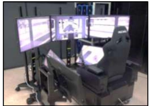
写真-1 開発した除雪グレーダシミュレータ
