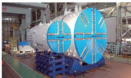
H&V 2連分岐型シールド機(右側外径9.0m、左側外径4.15m)
