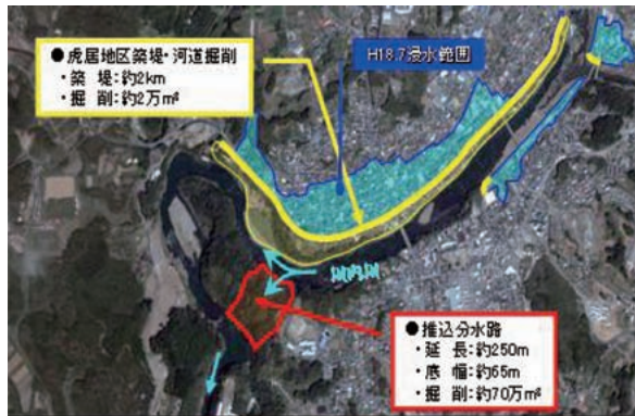
さつま町虎居地区（築堤、推込分水路）
